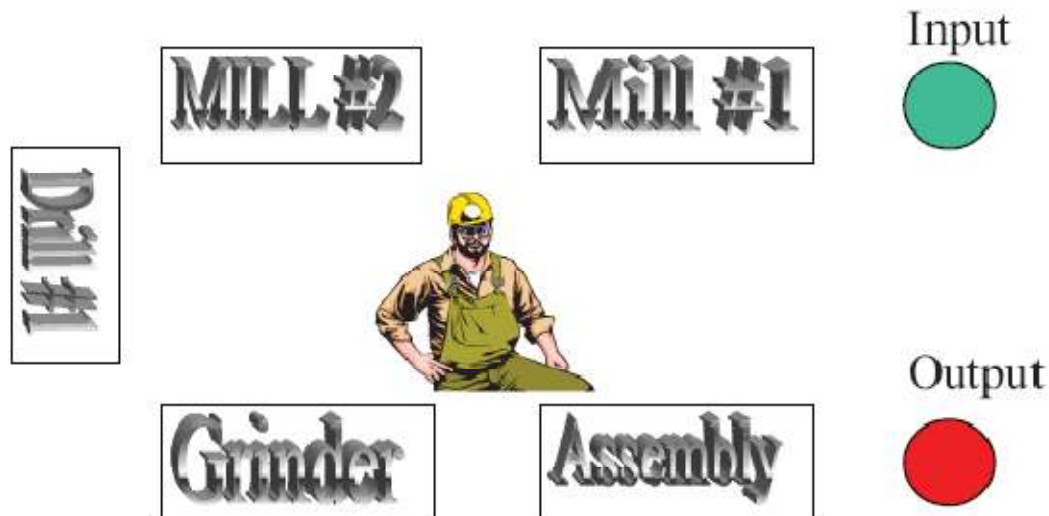
شکل ۵-۱۰- یک سلول تولید U شکل
